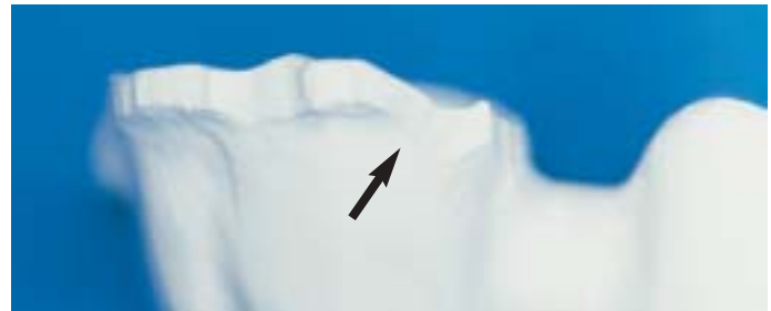
Abb. 16 Am Rand (Pfeil) ausgebrochene Gerüststruktur des Grünkörperrohlings
