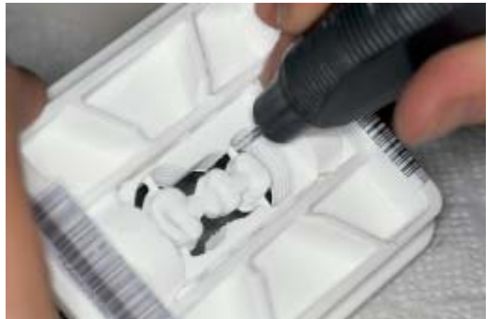
Abb. 17 Das Heraustrennen des fertig gefrästen Brückengerüstes
