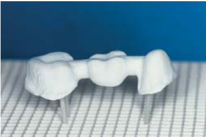
Abb. 22 Brückengerüst auf dem Sinterträger (man beachte die v-förmige Anordnung der Haltestifte)
