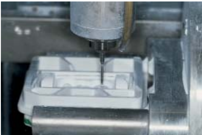
Abb. 15 Der eingespannte Brückenrohling in der Fräseinheit
