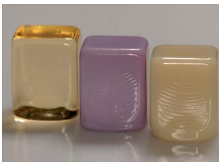
▲ Abb. 4: Die „Metamorphose“ von IPS e.max CAD-Blöcken vom Glas über das Lithium-Metasilikat zum Lithium-Disilikat (v.l.n.r.). ▲ Abb. 5: KaVo Everest CAD-Datensatz eines Dentinkernes für Zahn 21. ▲ Abb. 6: Kontrolle der gefrästen Kronen auf dem Meistermodell (im vorkristallinen Stadium).
