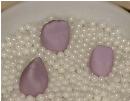
▲ Abb. 7 und 8: IPS e.max CAD-Dentinkerne auf dem Sinterträger vor und nach dem Kristallisationsbrand. Diese wurden aus IPS e.max CAD LT-Rohlingen gefertigt (LT = low translucency). ▲ Abb. 9: Nach dem Kristallisationsvorgang erhalten die Dentinkerne ihr endgültiges, zahnfarbenes Aussehen.
