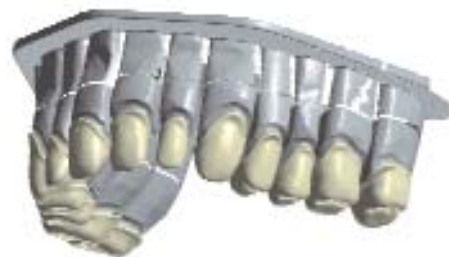
Abb. 6: 14 Einzelzahnkronenkappen als CAD-Datensatz.
